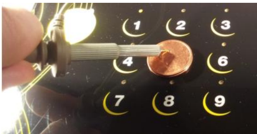
图 3-4 按键波形测试方法
