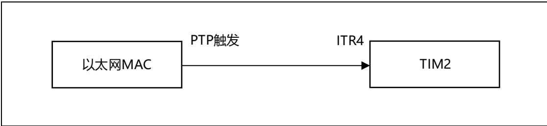
图 38-22. PTP 触发输出与 TIM2 ITR4 的连接
