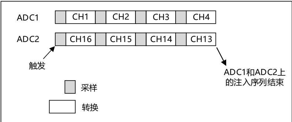
图 42-7 4 个通道的注入同步模式
